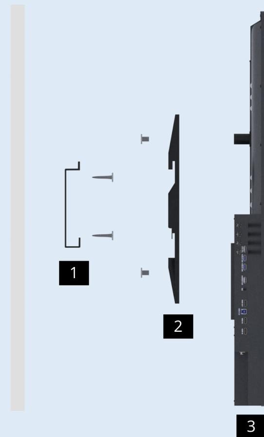
Установка происходит по средством фиксации OPS компьютера на корпусе устройства. Дополнительные провода питания не требуются.
